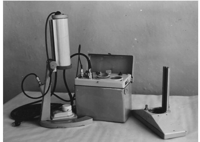
Abb. 4-2: Gerät zur kernphysikalischen Zinn-Gehaltsbestimmung im Labor MAK-1
